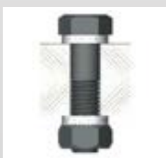
Agujero pasante Tornillo asegurado a ambos lados
