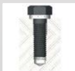
Agujero roscado Tornillo asegurado
